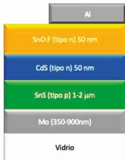
Figura 3. Diagrama esquemático de una celda solar de segunda generación.
